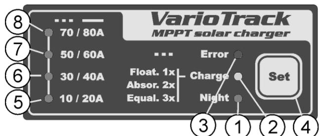
gestattet ist. Die Egalisierungsphase wird erlaubt sein nachdem die Set Taste (4) 2 Sek. gedrückt und mit einem Piepton bestätigt wurde. Die Signalleuchte "Charge" blinkt 3x; so lange bis die Egalisierungsphase beendet ist. Die Egalisierung kann unterbrochen werden, indem die Taste ein zweites Mal während 2 Sekunden betätigt wird. Durch einen doppelten Piepton wird angezeigt, dass die Funktion abgebrochen wurde. Die Leuchte (2) bestätigt den Abbruch durch dreimaliges Blinken.
