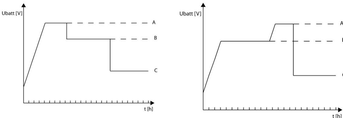
A= Egalisierungsspannung, B= Absorptionsspannung, C= Ladeerhaltungsspannung
